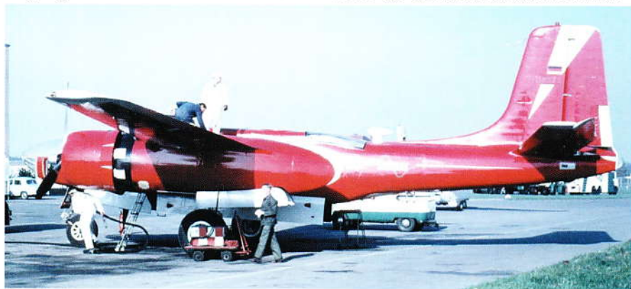
► Flugvorbereitungen an der D-CELE: Unter dem Heck die Proton-Magnetsonde in ihrer Halterung
