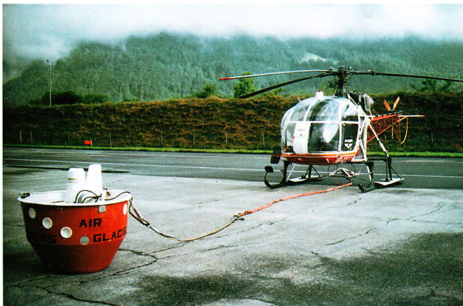
Der LAMA der Air-Glaciers kann 4 Personen und Nutzlast bis 900 kg mitführen. Im Vordergrund der 600-Liter-Behälter «Chadwick».
