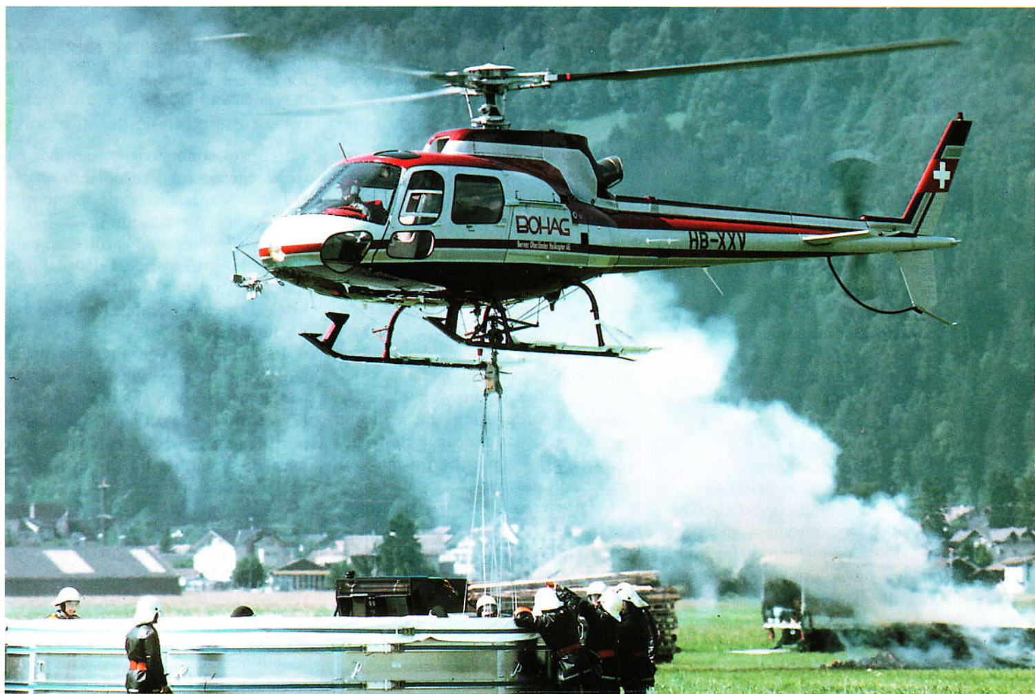
Der Ecoreuil B2 der BOHAG beim Füllen des Faltbehälters Bambi-Bucket.
